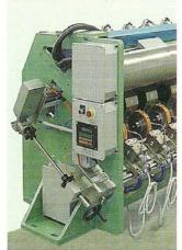
Sistema di taglio "EXPANDO" con guide lineari per scorrimento a ricircolo di sfere tipo "GL", con posizionamento manuale, visualizzato ed automatico con materiale inserito e non.
